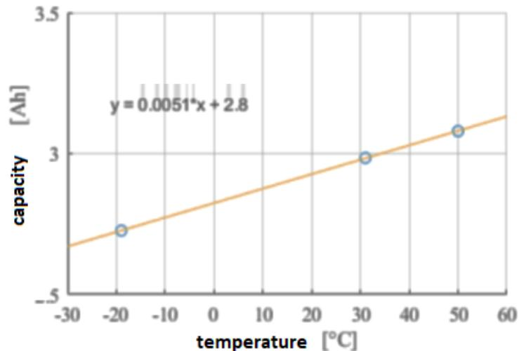
**Figure 3.** Dependence of lithium-ion battery capacity on temperature change. Source: Mazan B., Detka T. (2020). Eksperymentalne badanie wpływu temperatury ogniwa litowo-jonowego na pojemność i dokładność obliczeń stopnia naładowania. Napędy i sterowanie. Warszawa.
